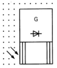
名称：用非电离辐射热源的热离子二极管发生器
