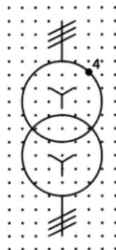
名称： 具有 4 个抽头的星形-星形连接的三相变压器
