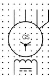
名称: 中性点引出的星形连接的三相同步发电机
