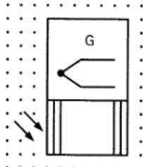
名称: 用非电离辐射热源的热电发生器
