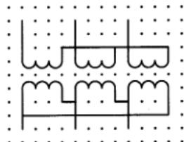
名称: 单相变压器组成的三相变压器,星形-三角形连接
