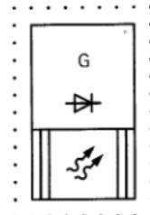
名称：用放射性同位素热源的热离子二极管发生器
