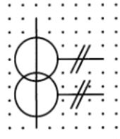
名称：在一个铁心上具有两个二次绕组的电流互感器
