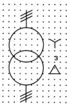
名称: 单相变压器组成的三相变压器,星形-三角形连接
