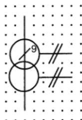
名称： 在同一个铁心有两个二次绕组的脉冲变压器或电流互感器
