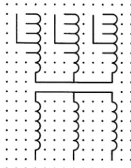
名称: 具有4个抽头的星形-星形连接的三相变压器
