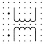
名称: 双绕组变压器(带瞬时电压极性指示)
